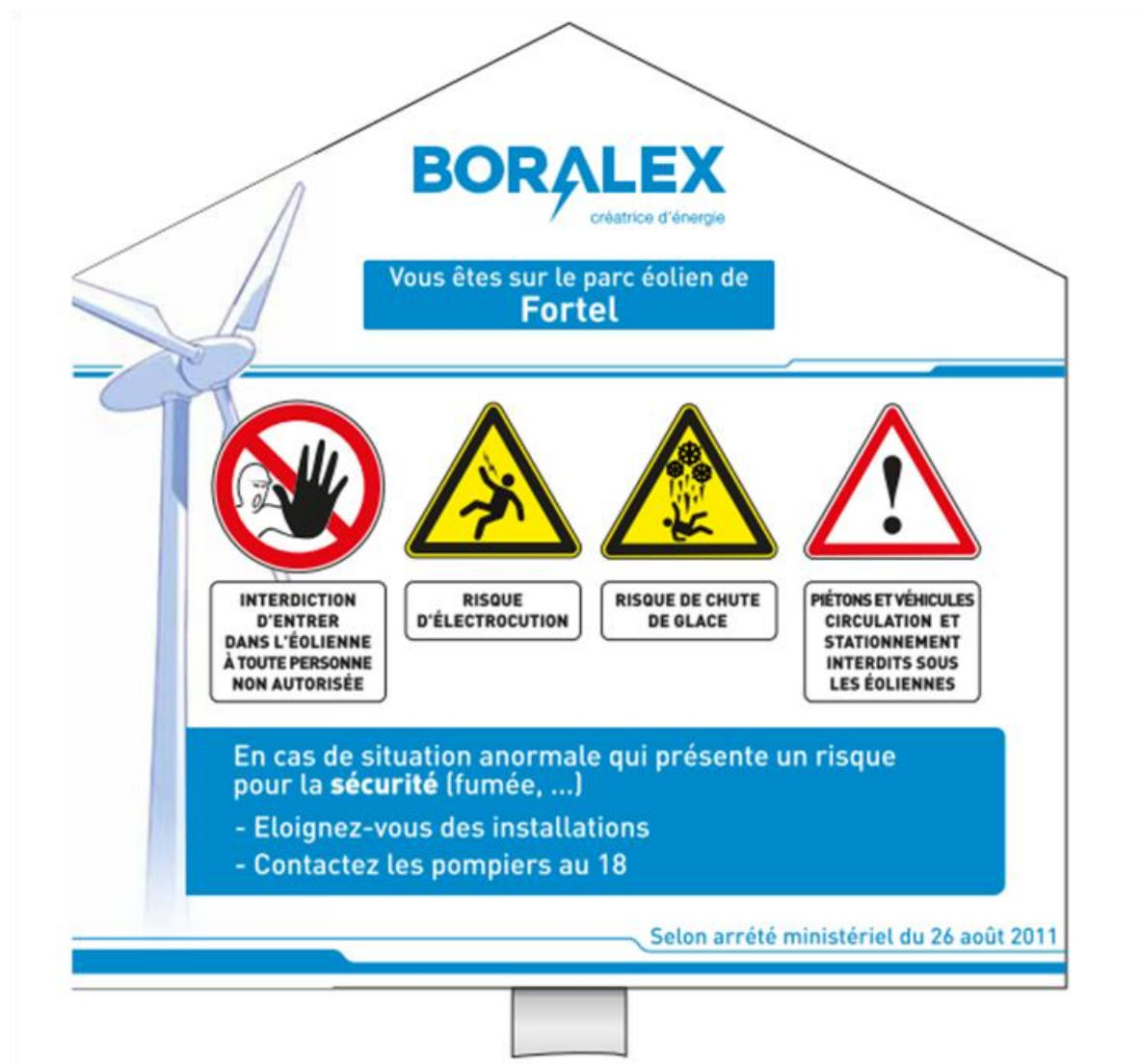
Figure 8 - Exemples de panneaux d'avertissement à l'entrée des plateformes des éoliennes
